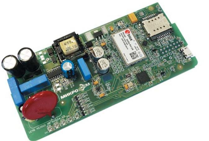
**Рис. 1.** Модем для счетчика электроэнергии
