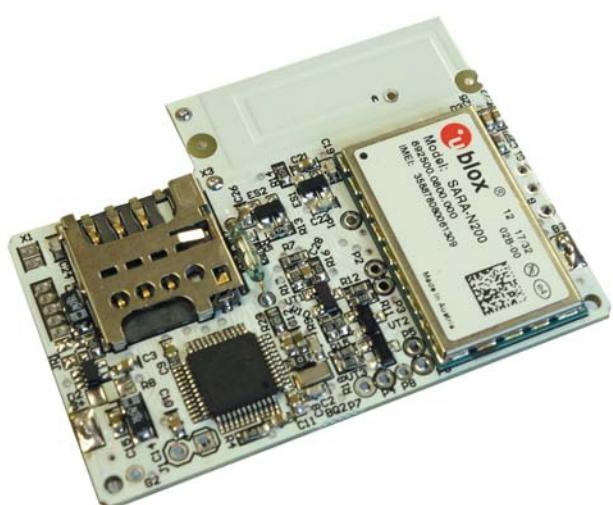
**Рис. 2.** Модем для счетчика воды
