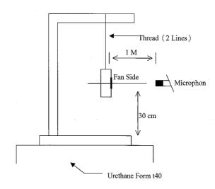
1 METER FROM MICROPHONE TO FAN INTAKE
