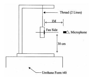
1 METER FROM MICROPHONE TO FAN INTAKE
