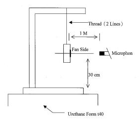
1 METER FROM MICROPHONE TO FAN INTAKE
