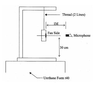
1 METER FROM MICROPHONE TO FAN INTAKE
