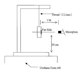
1 METER FROM MICROPHONE TO FAN INTAKE
