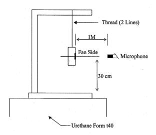
1 METER FROM MICROPHONE TO FAN INTAKE
