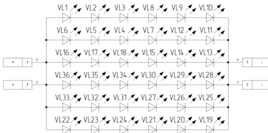
Рис.1 Схема электрическая модуля UEM S36-146x45-3030
