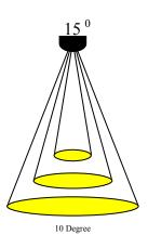
Light Dimansion Parameters  $1m/\varnothing$  : 0,26 m  $2m\,/\,\text{\o}$  : 0,52 m $3m / \emptyset$ : 1,10 m
