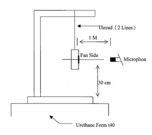
1 METER FROM MICROPHONE TO FAN INTAKE
