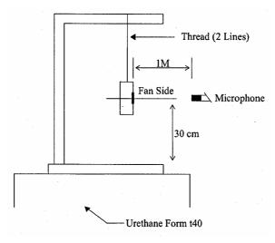
1 METER FROM MICROPHONE TO FAN INTAKE
