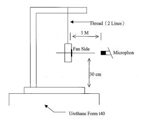
1 METER FROM MICROPHONE TO FAN INTAKE
