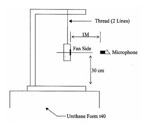
1 METER FROM MICROPHONE TO FAN INTAKE
