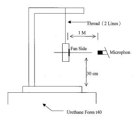
1 METER FROM MICROPHONE TO FAN INTAKE
