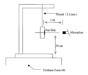
1 METER FROM MICROPHONE TO FAN INTAKE
