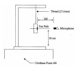
1 METER FROM MICROPHONE TO FAN INTAKE
