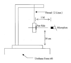
1 METER FROM MICROPHONE TO FAN INTAKE
