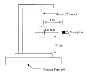
1 METER FROM MICROPHONE TO FAN INTAKE
