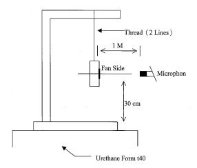
1 METER FROM MICROPHONE TO FAN INTAKE
