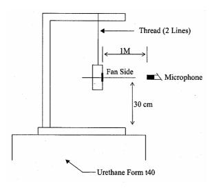
1 METER FROM MICROPHONE TO FAN INTAKE
