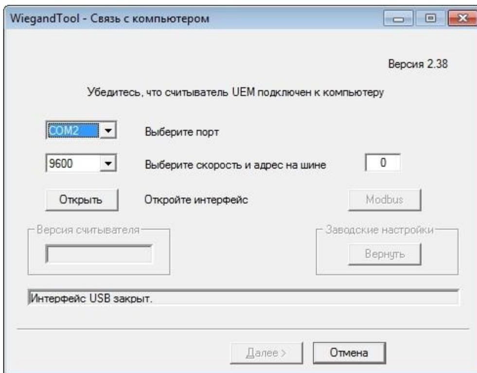
Здесь можно выбрать интерфейс, с помощью которого считыватель подключен к компьютеру. Это может быть USB или COM-порт (RS232 или RS485).
