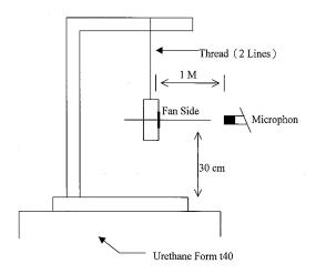
1 METER FROM MICROPHONE TO FAN INTAKE
