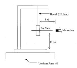
1 METER FROM MICROPHONE TO FAN INTAKE
