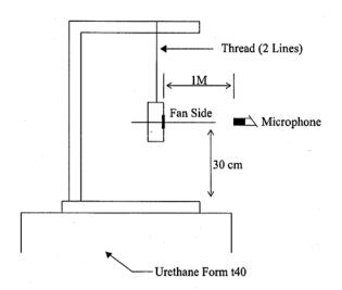
1 METER FROM MICROPHONE TO FAN INTAKE
