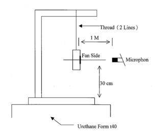
1 METER FROM MICROPHONE TO FAN INTAKE
