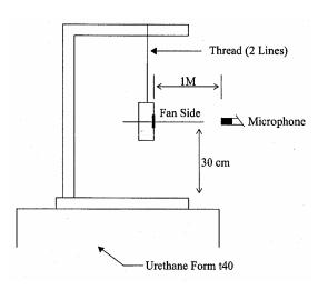
1 METER FROM MICROPHONE TO FAN INTAKE
