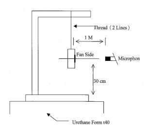
1 METER FROM MICROPHONE TO FAN INTAKE
