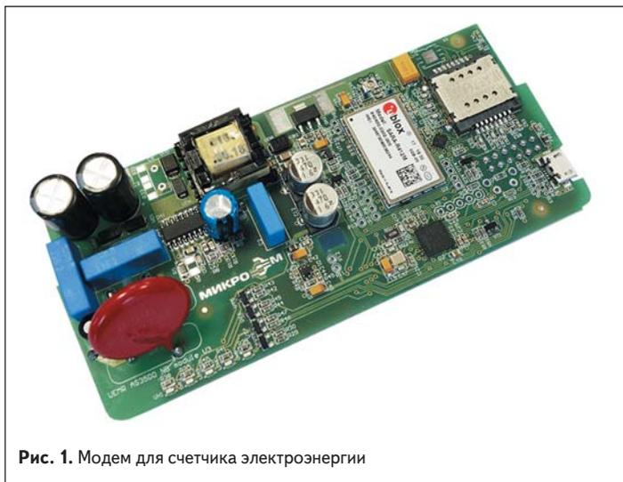
Рис. 1. Модем для счетчика электроэнергии
