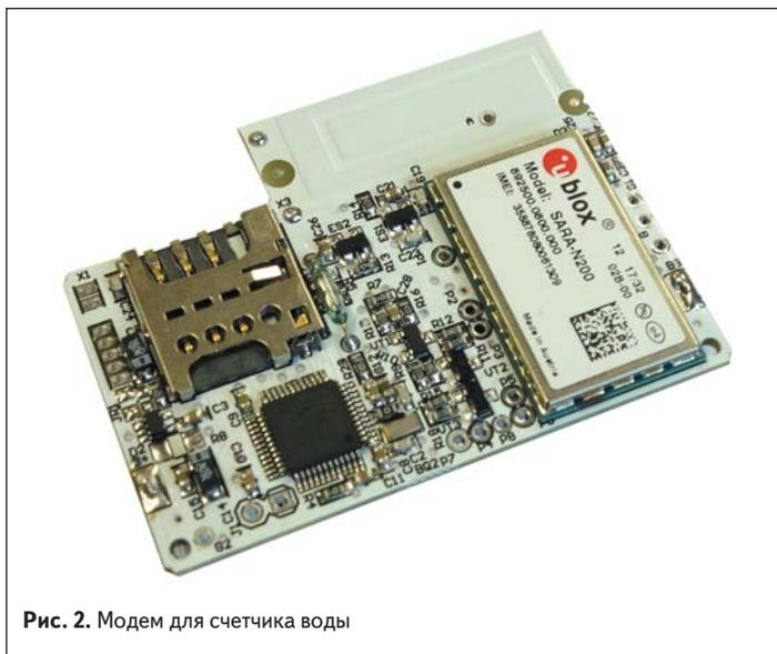
Рис. 2. Модем для счетчика воды
